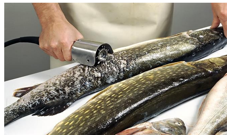
Рисунок 3.7. Использование рыбоочистительной машины РО-1М
