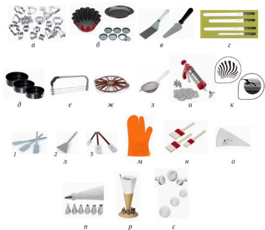
Рис. 11.8. Инструменты и приспособления кондитерского цеха: а — фигурные вырезки; б — формы для выпечки и формы для тарталеток; в — лопатки; г — кондитерские ножи; д — формы для тортов; е — пила для нарезания бисквита с тремя лезвиями переменной высоты; ж — делитель тортов на порции; з — кондитерское ситечко для создания рельефных изображений; и — шприц-пресс для теста (шприц-дозатор); к — трафареты для украшения тортов аэрографией; л — лопатки кондитерские: 1 — для перемешивания, замешивания теста и аналогичных вязких кондитерских масс; 2 — треугольная лопатка-шпатель; 3 — силиконовые лопатки; м — силиконовая рукавица; н — кисти кондитерские; о — мешок кондитерский; п — насадки для кондитерских мешков; р — подставка для кондитерских мешков; с — вырубки
