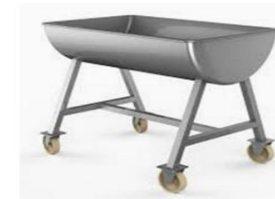
Рисунок 4.4. Немеханическое оборудование овощного цеха: а — производственный стол со встроенной ванной; б — производственный стол марки ССОП с отверстием в центре для удаления пищевых отходов; в — моечные ванны передвижные
