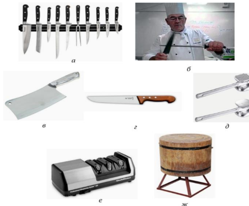
Рисунок 6.1. Инвентарь и оборудование мясного цеха: а — набор ножей с креплением к стене; б — заточка ножа с помощью мусата; в — нож-рубак; г — нож обвалочно-универсальный; д — молотки для отбивания мяса алюминиевые; е — аппарат для заточки ножей; ж — колода разрубочная
