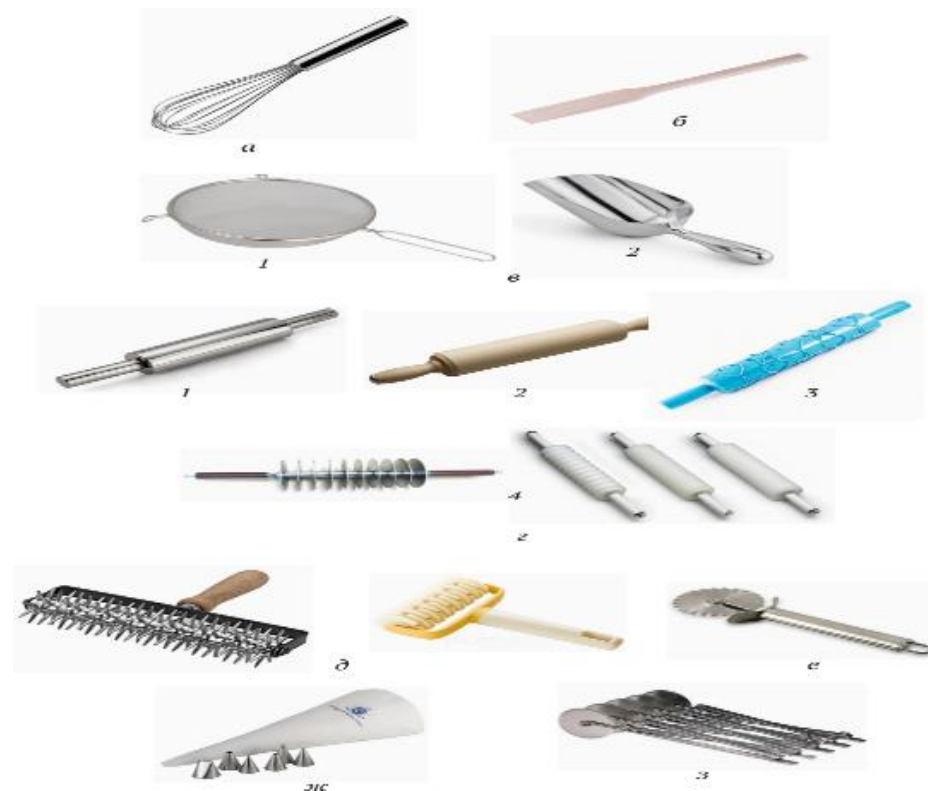
Рисунок 11.6. Инвентарь кондитерского цеха: а — венчик; б — веселка; в — инвентарь для муки: 1 — сито; 2 — совок; г — скалки: 1 — металлическая; 2 — деревянная; 3 — скалка с вырезанными штампами; 4 — скалки тестоделительные; д — валики, делающие решетку на тесте; е — нож для теста; ж — кондитерский мешок; з — приспособление для нарезки теста
