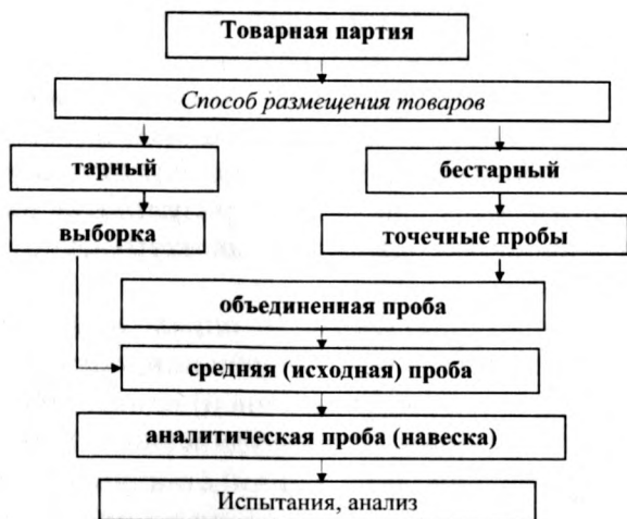
Рис. 1.2. Схема отбора и составления проб от товарных партий при разных способах размещения продовольственных товаров
