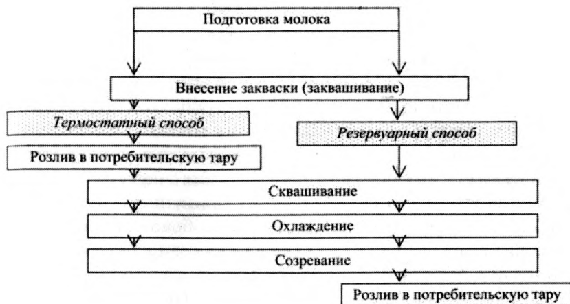
Рис. 3.2. Технологическая схема производства жидких кисломолочных продуктов
