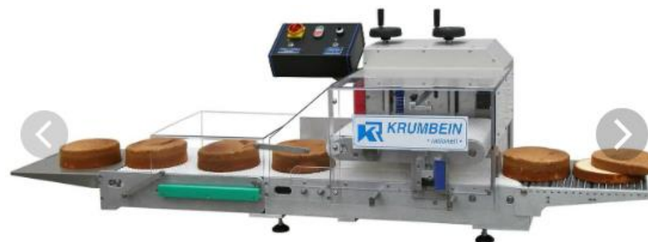
Рисунок 34.1 Настольная машина для горизонтальной нарезки бисквита
