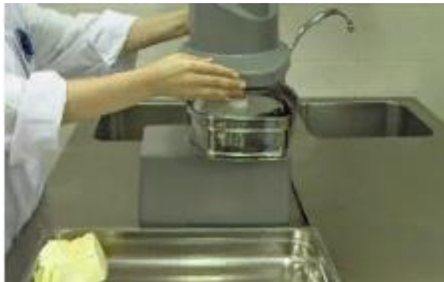
Рисунок 4.9 Установка улиткообразного загрузочного бункера
