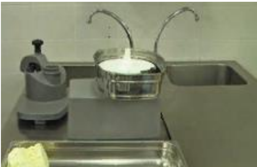
Рисунок 4.7 Проверка правильности установки диска-сбрасывателя (поворот по часовой стрелке)
