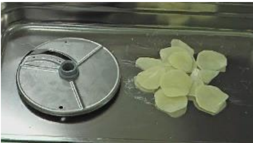
Рисунок 4.4 Дискový нож (кружочки и для шинкования капусты)
