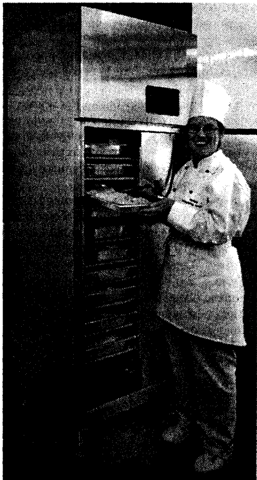
Рис. 3.4 Шкаф интенсивного охлаждения
