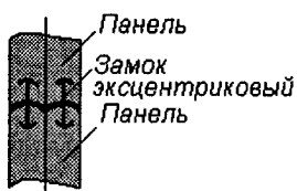
Рис. 15.29 Узел соединения панелей холодильной камеры
