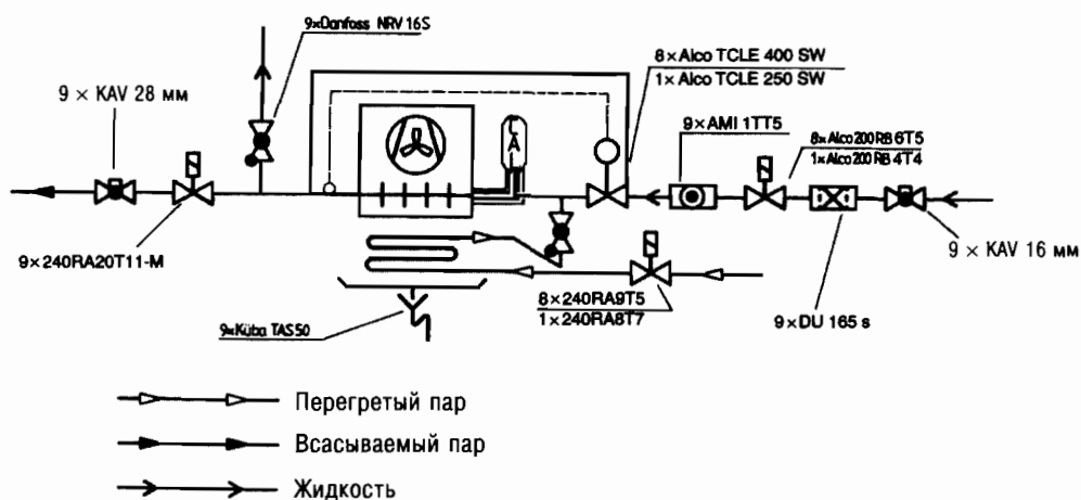
Рис. 4.54. Элементы системы управления и контроля испарителей
