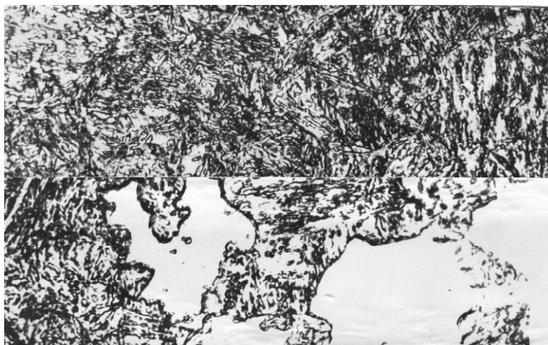
Рис. 3.8. Микроструктура стали 20 после цементации и термической обработки (x725)(поверхность – мартенсит, сердцевина – феррит + перлит)
