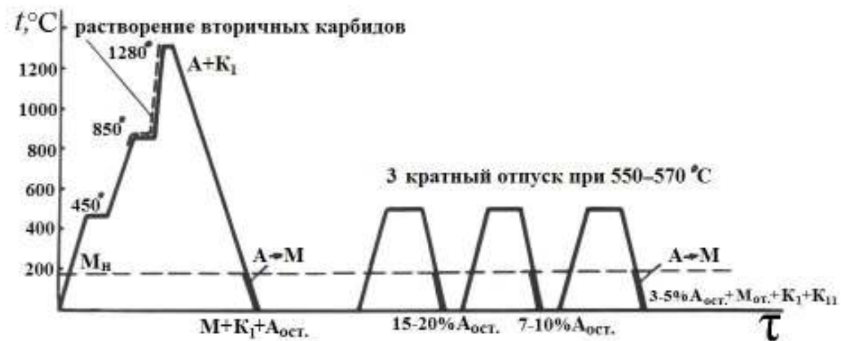
Рис. 4.8. Схема термической обработки быстрорежущей стали
