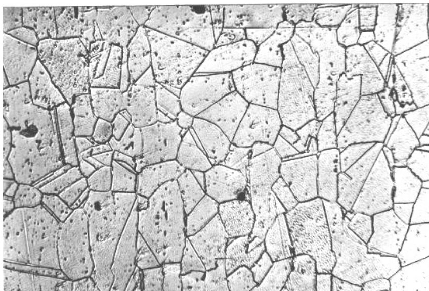
Рис. 4.4. Структура аустенитной нержавеющей стали 12Х18Н10Т
