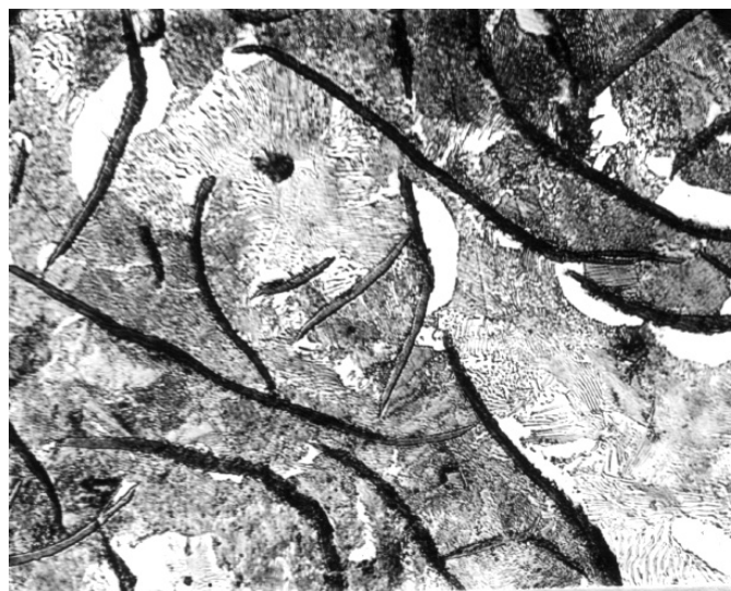
Рис. 4.2. Микроструктура серого чугуна на феррито-перлитной основе
